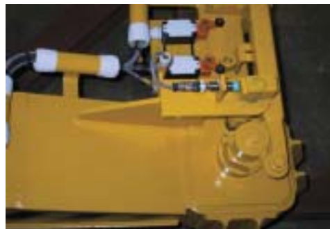
Elektrische Überwachung Containerspreader Twist Lock
