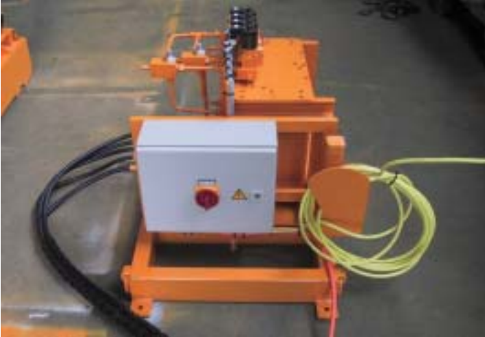
Extern aufgestelltes Pumpenaggregat für Hydraulik-Kipptisch
