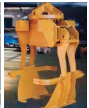
Elektrohydraulischer Greifer mit Horizontaldrehwerk zum Greifen von gebündeltem Material
