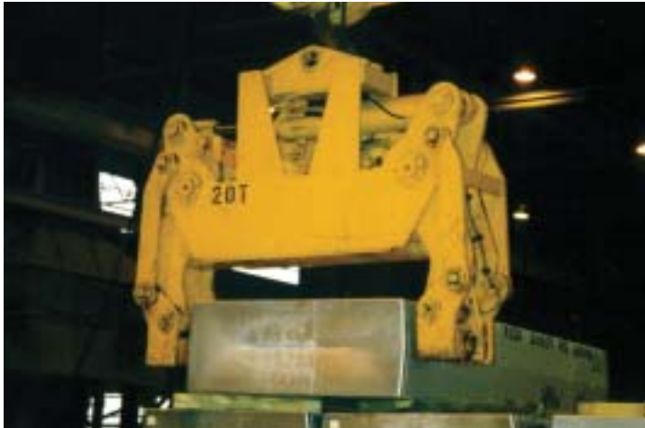
Elektrohydraulische Parallelogramm-Blockzange zum Aufrichten und Umlegen von Aluminiumblöcken
