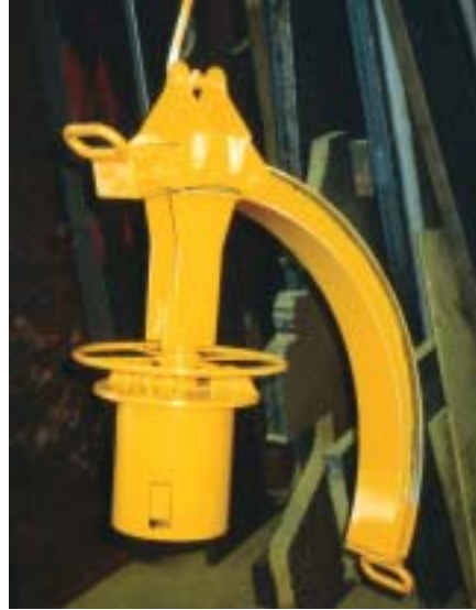
Manuell betätigter Spreizdorn mit 90° Wendevorrichtung für Papierrollen, die im Innenkern gegriffen werden
