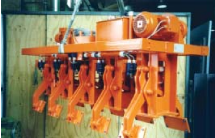
Elektrohydraulisches Zangengehäuge zum Greifen von Schrottbällen
