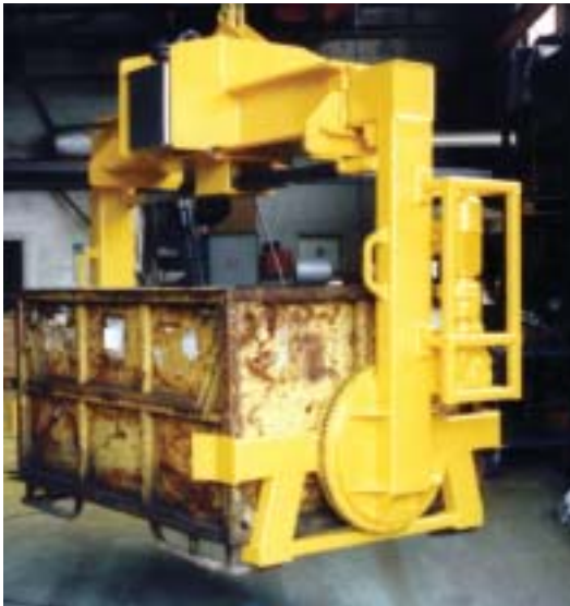
Elektromotorischer/Elektrohydraulischer Schrottkübelgreifer zum Ausschütten
