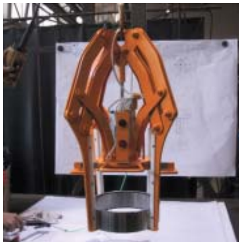
Pneumatisch betätigter Vierarmgreifer für Ver- packungsvorgänge
