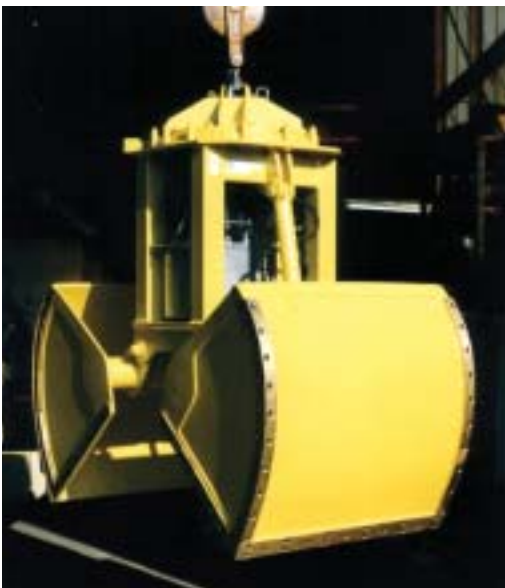
Zweischalengreifer - Einsatz im Ex-Bereich
