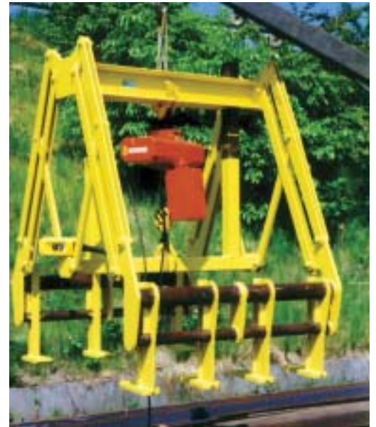
Parallelogrammgreifer: Das Öffnen und Schließen erfolgt über einen Elektrokettenzug
