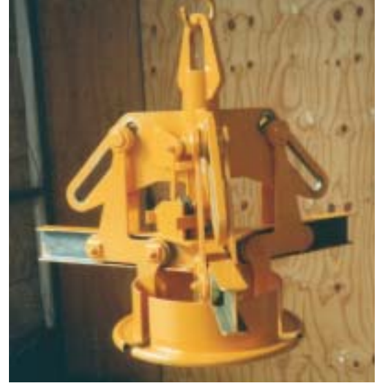
3-armiger Unterfassgreifer mit Aufsetzautomatik
