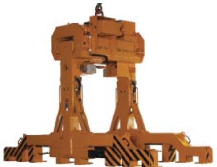
Elektromotorischer Teleskop-Blechpaketgreifer mit fest stehenden mittigen Greiferfüßen und mit zusätzlichen manuell ausziehbaren Greiferfüßen und elektrohydraulisch ausschwenkbaren äußeren Greiferfüßen
