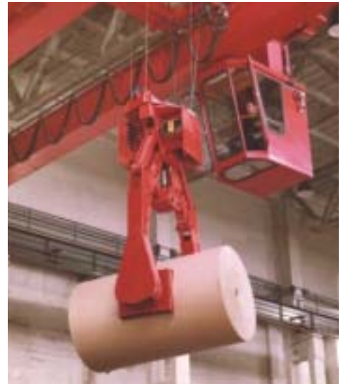
Elektrohydraulischer Papierrollengreifer mit 90° Schwenkwerk
