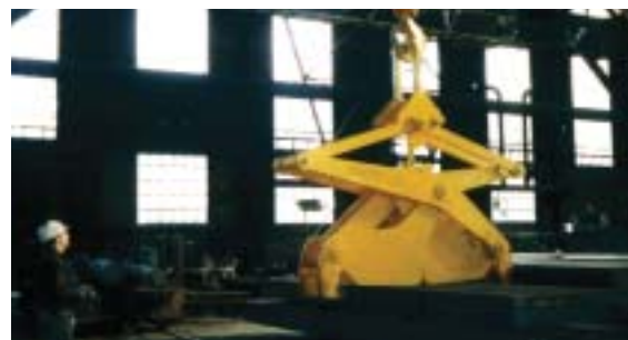
Viergelenkpunktzange in minimaler und maximaler Greifstellung
