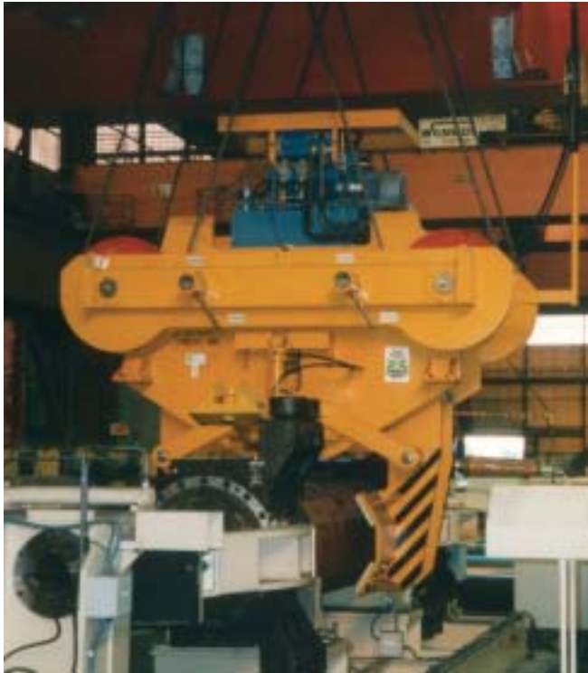
Elektrohydraulischer Walzengreifer zum Ein- und Ausbringen in eine Walzenschleifmaschine
