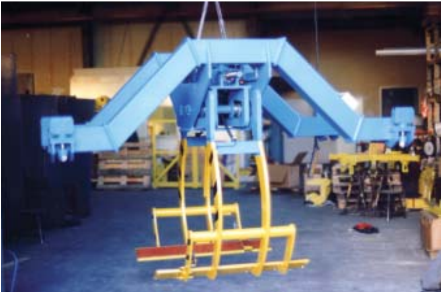
Elektromotorischer Papierrollengreifer, Einsatz in vollautomatischer Fertigungsstrasse
