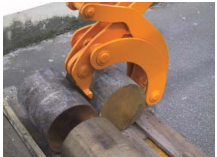
Asymmetrischer Rundgreifer für pyramidenförmig gestapeltes Rund- material
